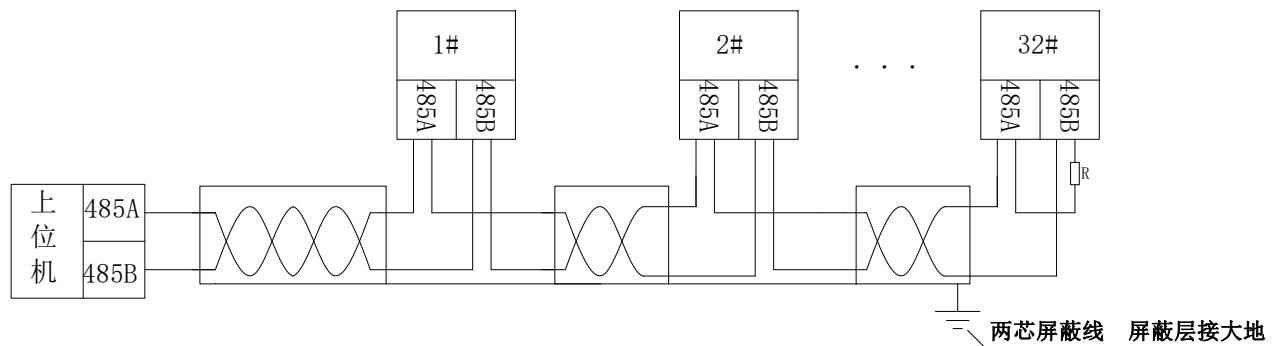
建议最末端仪表的 A、B 之间加匹配电阻，阻值范围为  $120\Omega \sim 10\text{ k}\Omega$ 。
