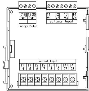
(A2) 电压电流信号输入
