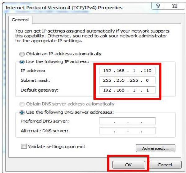
用双绞线 B 类网线连接以太网模块和电脑，给仪表通电。此时，电脑显示器中的右下角出现本地连接现已连接上，则可继续下一步操作。否则，仪表断电，检查网线，网络设置。
