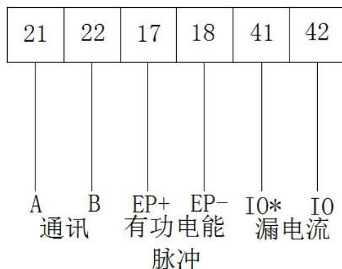
图 6 DDSY1352-4DM(5DM)辅助端子示意图
